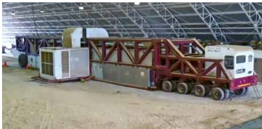
Obr. 2 Zariadenie simulátora ťažkého dopravného zaťaženia používané pri testoch ERDC
