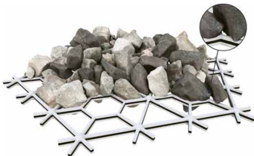
Obr. 1 Mechanizmus zaklinenia kameniva do otvorov šesťuholníkovej geomreže Tensor
